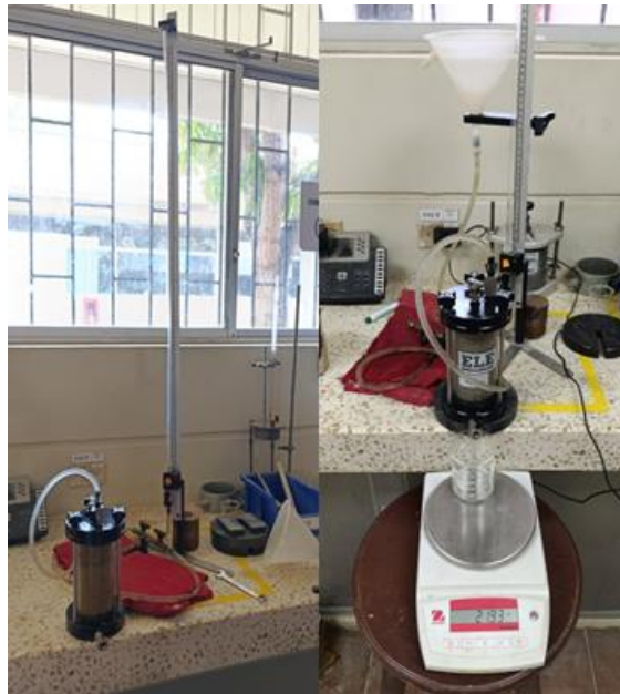
Figura 24 Ensayo de permeabilidad
