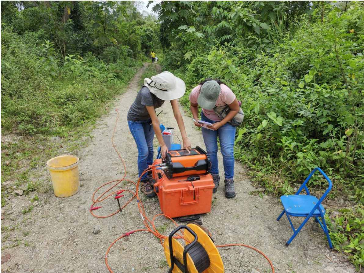
Figura 22 Arreglo de equipos para ensayos de TGE
