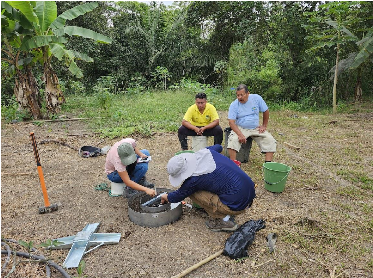
Figura 24 Ensayo de tasa de infiltración
