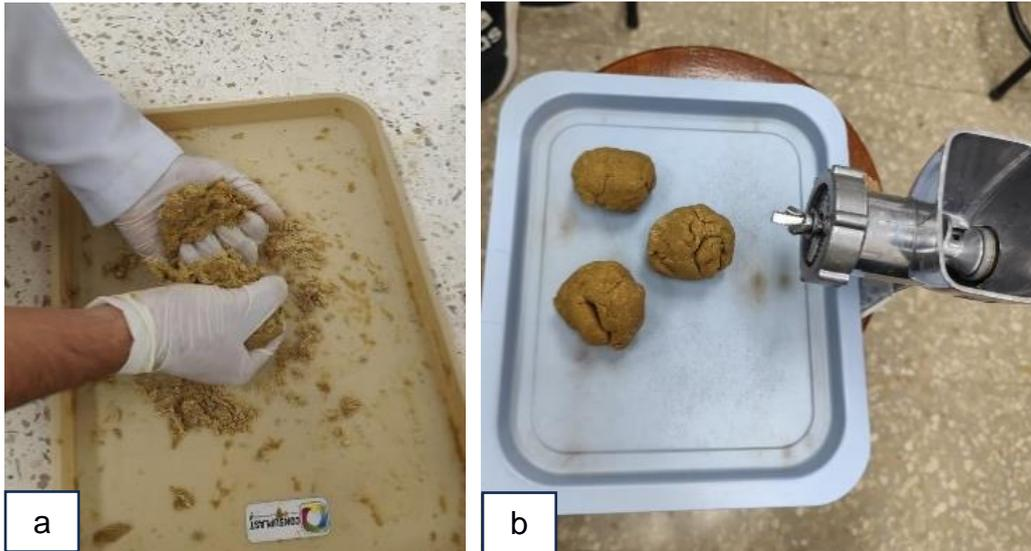
*Figura 4-a. Amasado de la mezcla; b. Formación de las esferas compactadas.*
