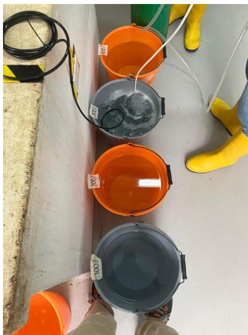
Figura 9. Preparación del agua sobresaturada.
