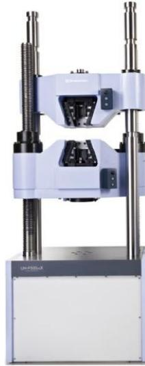
Nota: Ilustración tomada de UH-X/FX Series - Hydraulic Universal Testing Machines (Shimadzu Latin America).
