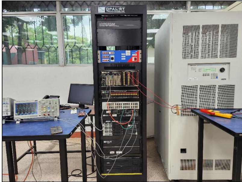
Figura 3. 24 Setup experimental con simulador OPAL-RT, Amplificador AMETEK y equipos de medición
