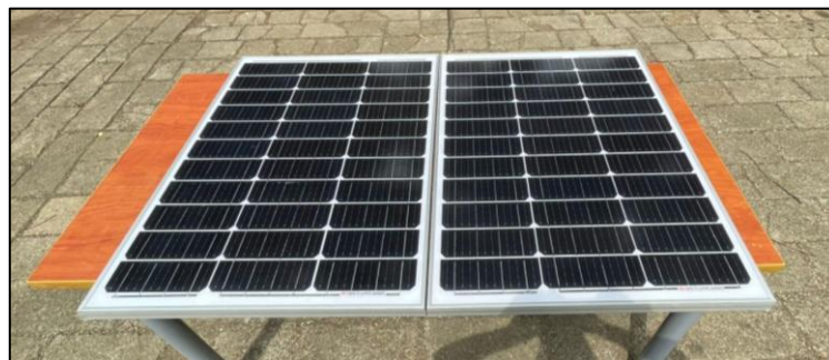
Figura 3. 23 Paneles fotovoltaicos SA-50 conectados en serie durante pruebas solares
