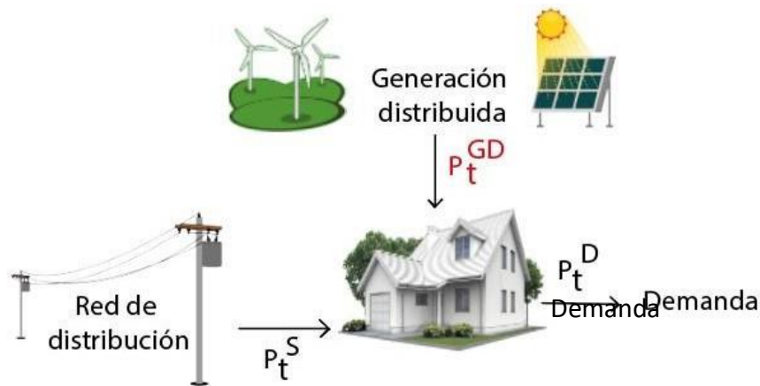
Figura 2.6: Gestión de energía residencial con generación distribuida
