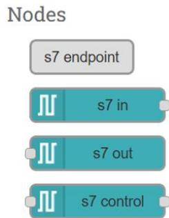
**Ilustración 9: Nodos de Comunicación S7**
