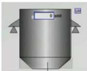
Representada en la parte superior de la pantalla, muestra el nivel de material almacenado, indicado por una lectura digital. Este nivel es fundamental para mantener el flujo continuo hacia las mangas de despacho.
