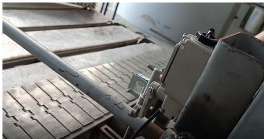
*Ilustración 32. Final de carrera para Límite en la Zona de Descarga*
