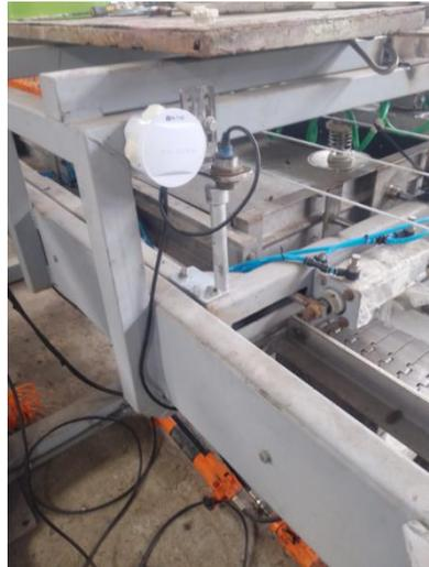
*Ilustración 36. Sensor Inductivo para presencia de posición central de Carro Transferidor de Botellas*
