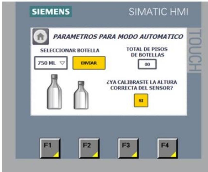
*Ilustración 52. Confirmación de tamaño de botellas y calibración.*
