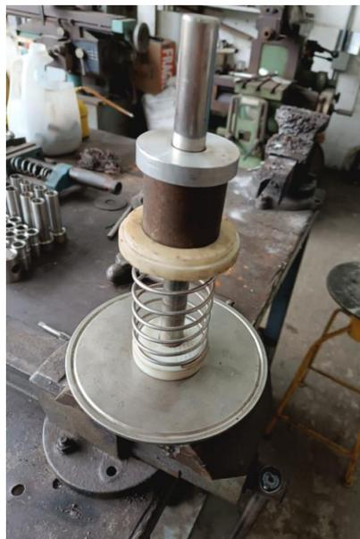
**Ilustración 35.** Sensor Mecánico, presencia Pallet para cerrar prensa de móvil para transferir botellas a zona de descarga
