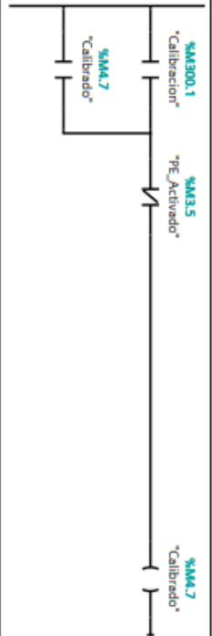
**Network 2 : Selección de Botellas para la regulación de Sensor de Presencia de Pallet de Botellas**
