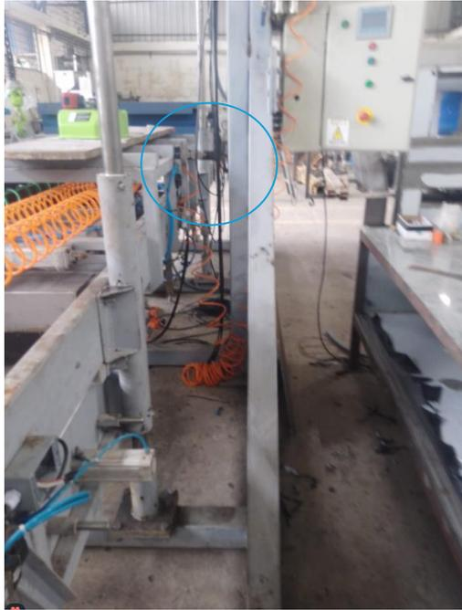
**Ilustración 34.** Final de carrera en el límite inferior.3
