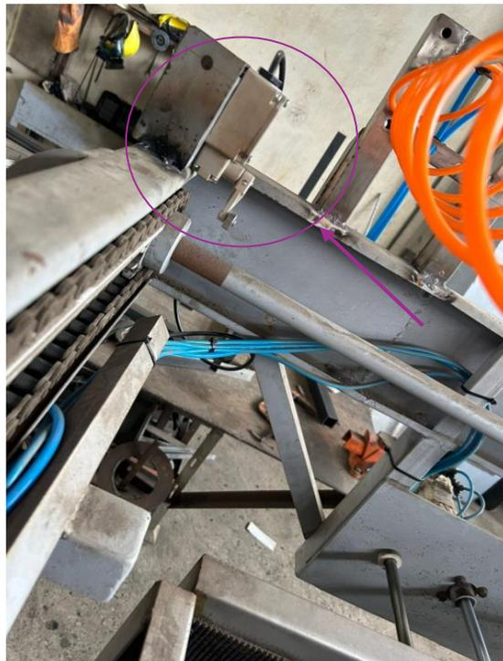
**Ilustración 31.** Final de carrera para Límite en la Zona de Carga
