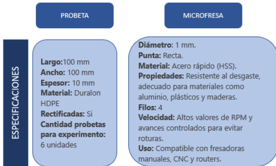
Figura 2.14 Especificaciones fresadora y microfresa utilizadas para experimento.
