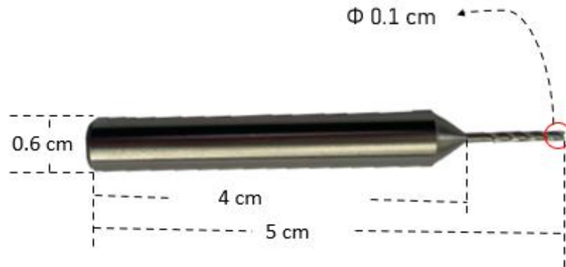
Figura 2.16 Dimensiones fresa HSS
