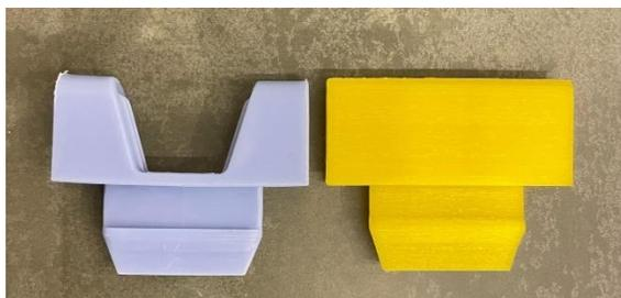
Figura 19. Comparación bisagra original vs rediseño 3.0.
