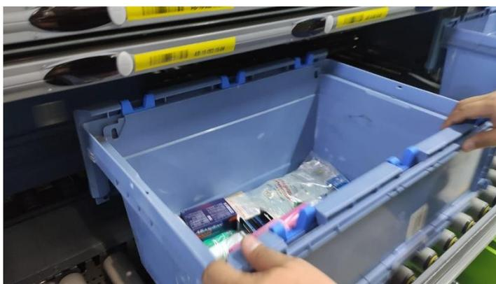
Figura 9. UCP ensamblada con bisagras impresas en 3D (diseño original).
