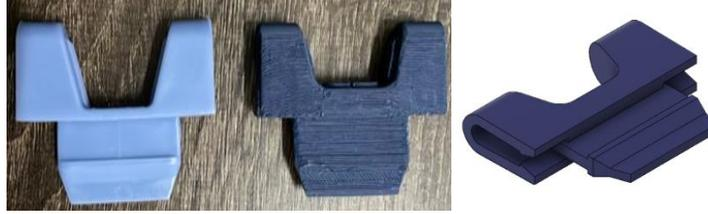
Figura 13. Rediseño 1.0 con refuerzo en la zona concentradora de esfuerzos.
