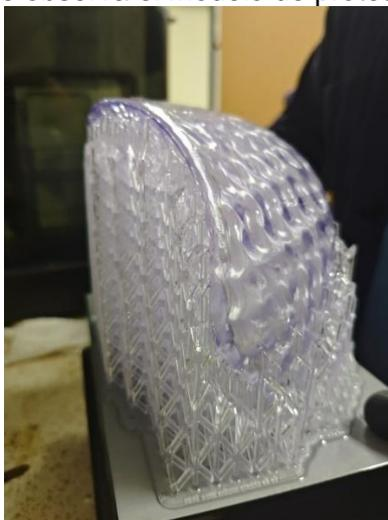
**Ilustración 41: Modelo de prótesis impreso por tecnología SLA**
