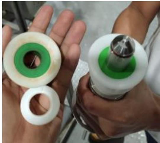
**Figura 2.34 Comparación de actuador borracha viejo versus nuevo**
