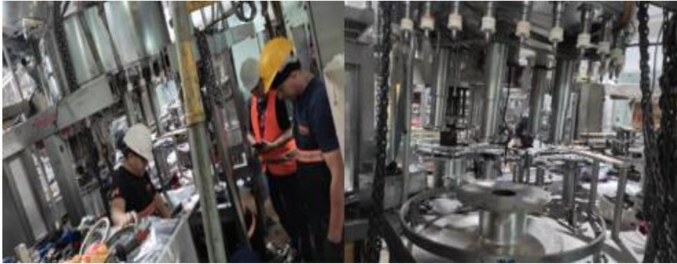
**Figura 2.27 Desmontaje de la envasadora**
