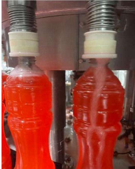
**Figura 2.19 Dosificación de válvulas con distinto desgaste**
