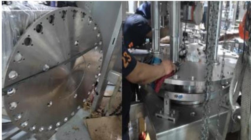
**Figura 2.32 Montaje de la nueva base del sistema de llenado**
