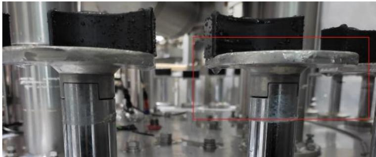
**Figura 2.15 Desgaste de pedales**
