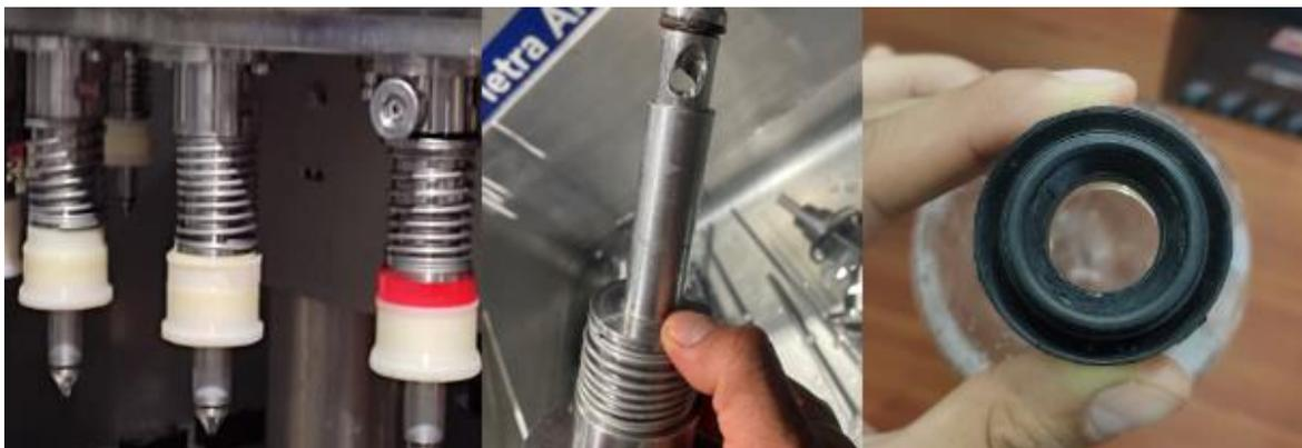
**Figura 2.24 Sobredosificación ocasionada por desgaste de actuadores**
