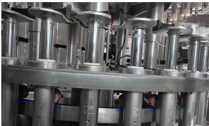
**Figura 2.16 Rodamientos con desgaste del sistema de pedales**
