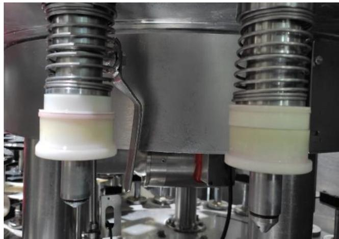
**Figura 2.13 Válvulas de distintas dimensiones**
