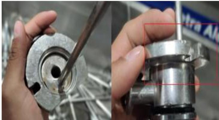
**Figura 2.20 Desgaste de válvulas de llenado**
