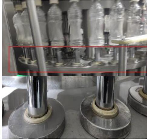
**Figura 2.21 Diferencia de nivel de los pedales**
