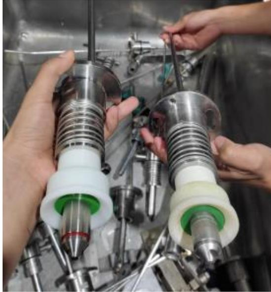
**Figura 2.35 Comparación de actuadores nuevos vs desgastados**
