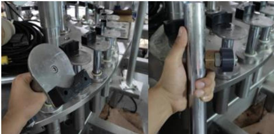
**Figura 2.30 Corrección en pedales y rodamientos de la envasadora**
