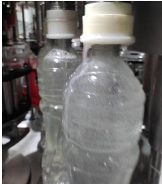
**Figura 2.22 Fuga ocasionada por desgaste de base de los pedales**
