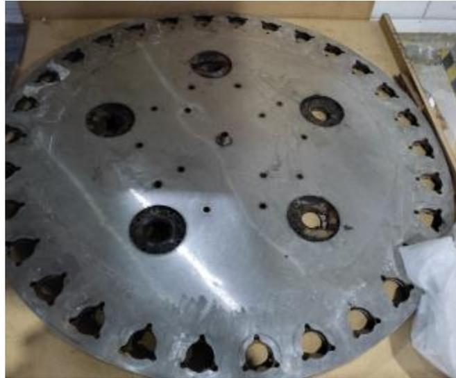
**Figura 2.23 Desgaste de la base de los pedales**
