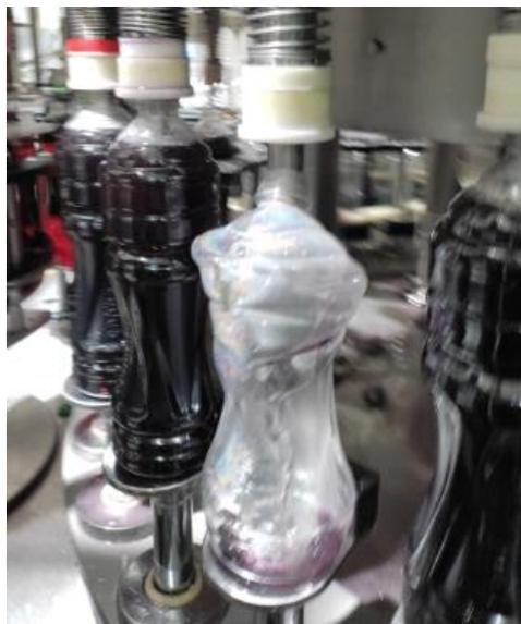
**Figura 2.17 Merma generada por desnivel entre pedal y válvula**
