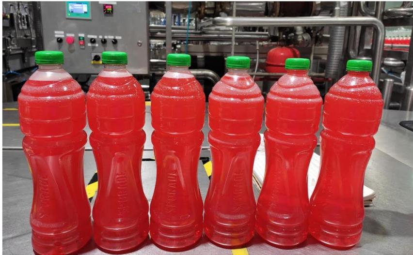
**Figura 2.25 Sobredosificación ocasionada por causas verificadas**
