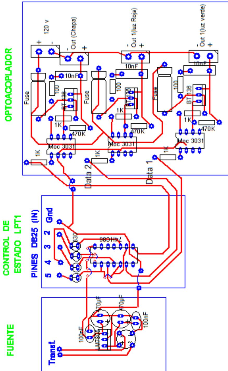
**Figura 16.-** Circuito Impreso Control de Estado y Circuito Optoacoplador
