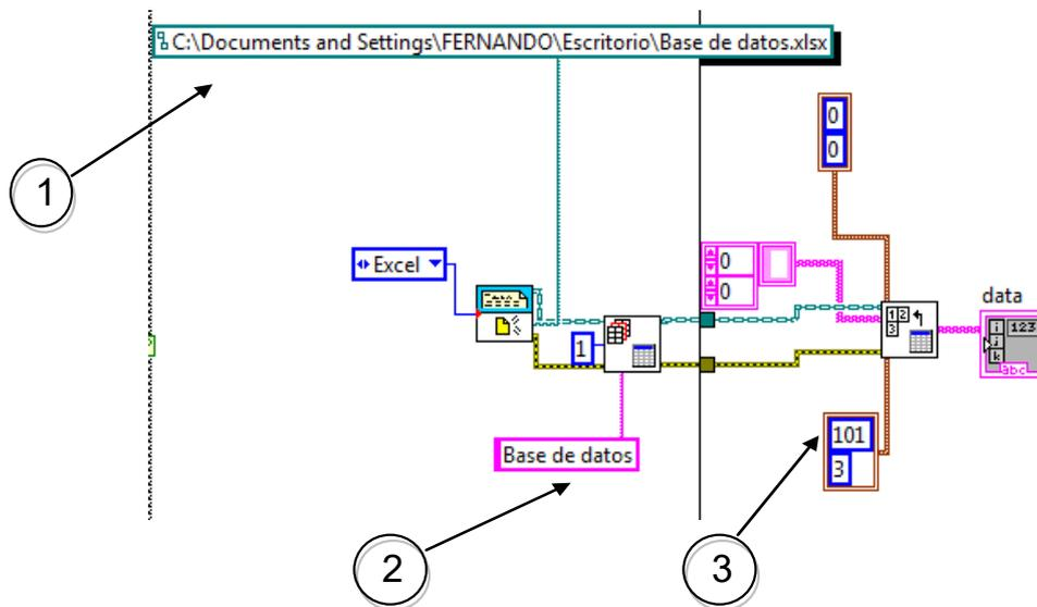
**Figura 4.-Configuración de la hoja de Excel enLABVIEW**
