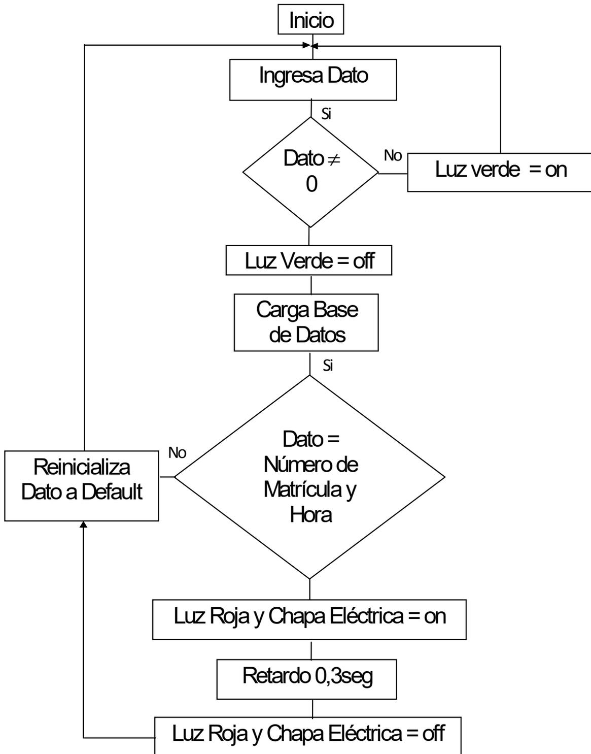
**Figura 3.-Diagrama de Flujo del “Control de Acceso”**
