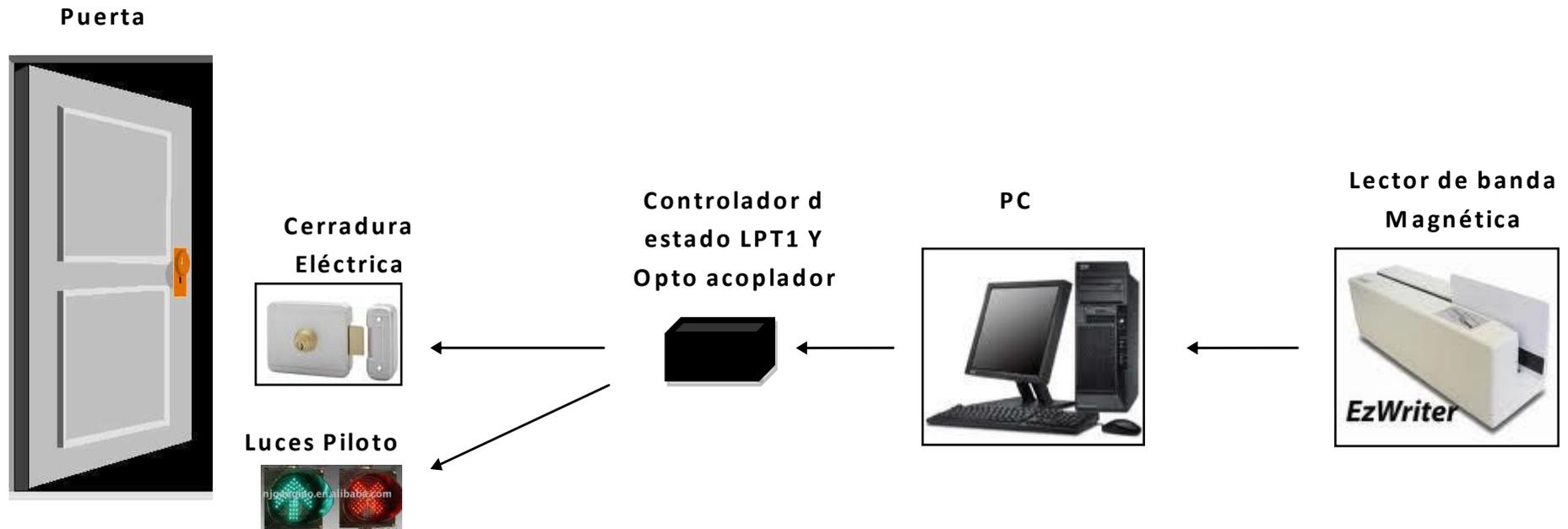
*Figura 1.- Diagrama de bloques del prototipo*
