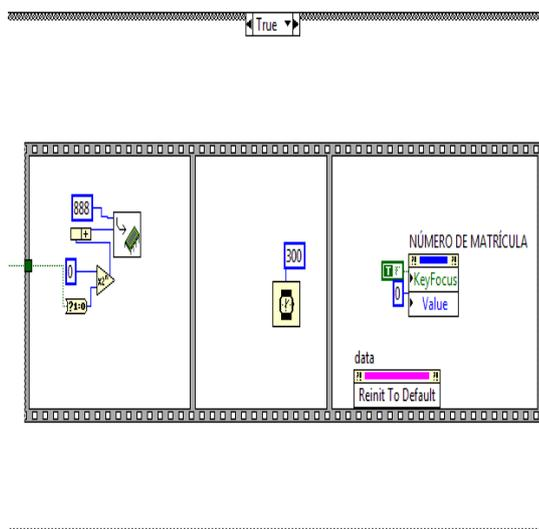
**Figura 22.-**Si los datos anteriores son verdaderos, procede a enviar el dato para abrir la cerradura eléctrica
