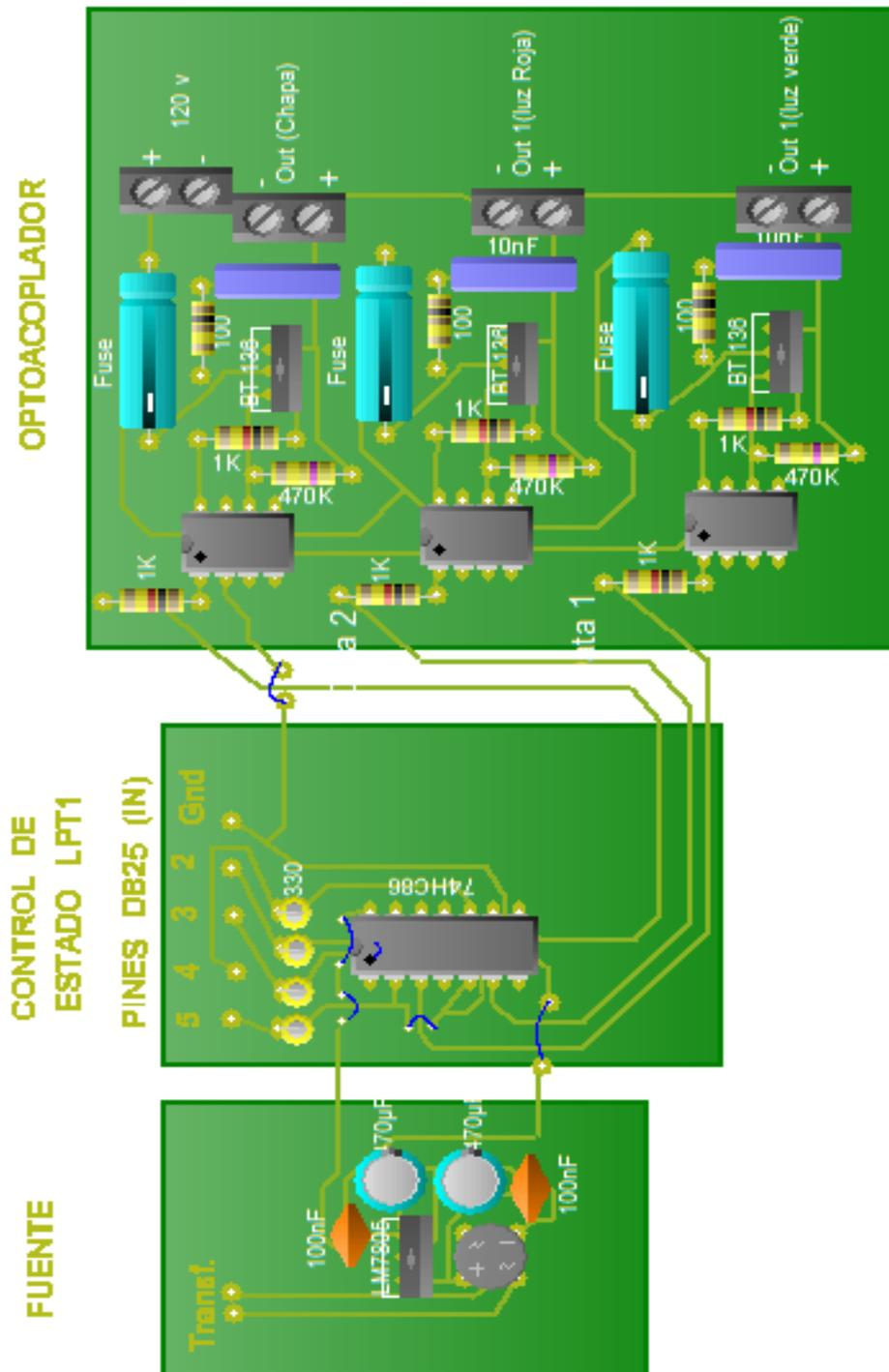
***Figura 17.-Circuito PCB Control de Estado y Circuito Optoacoplador***
