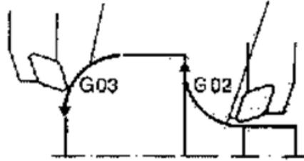
Figura 2.6 Desplazamiento Circular con G02 y G03
