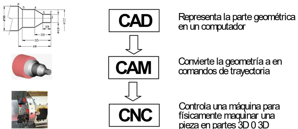
Figura 2.1 Proceso CAD-CAM-CNC para maquinado de una pieza
