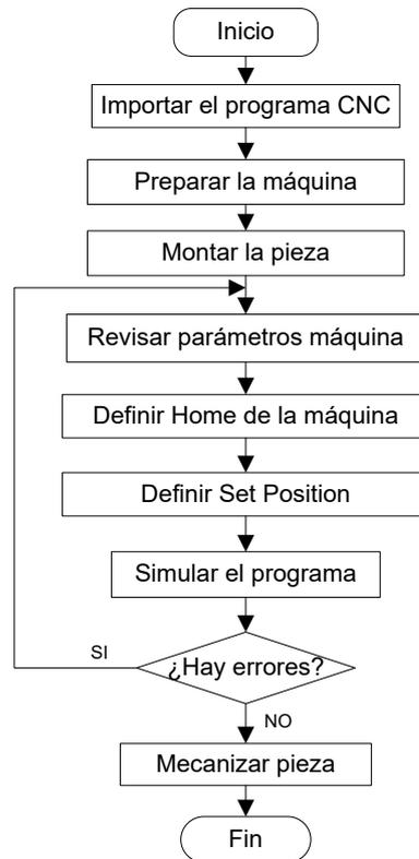
Figura 3.4 Hoja de Ruta de Proceso de Mecanizado
