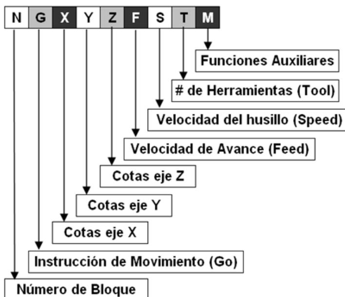
Figura 2.4 Estructura de una línea ó bloque CN
