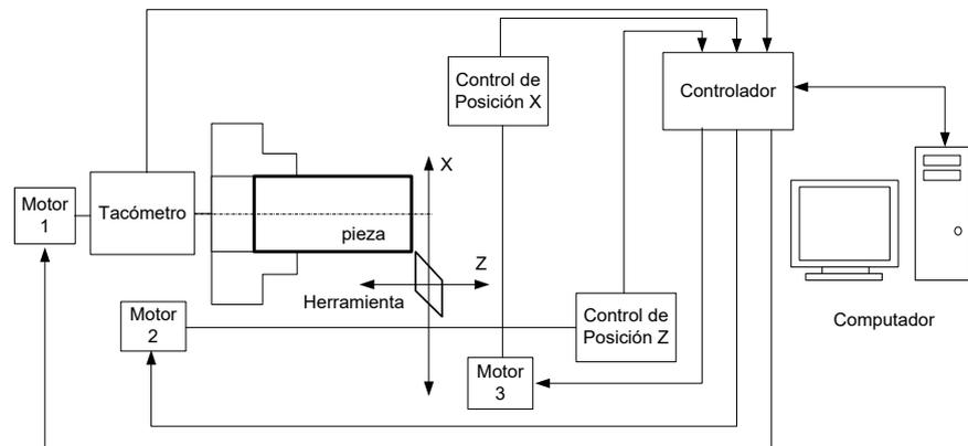
Figura 2.3 Elementos básicos de una máquina CNC
