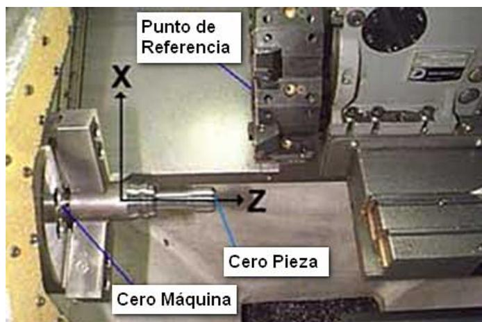
Figura 2.7 Puntos de referencia en torno CNC
