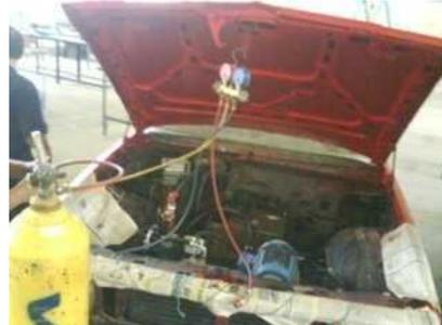
FIG-4.32 PRUEBAS CON NITRÓGENO
