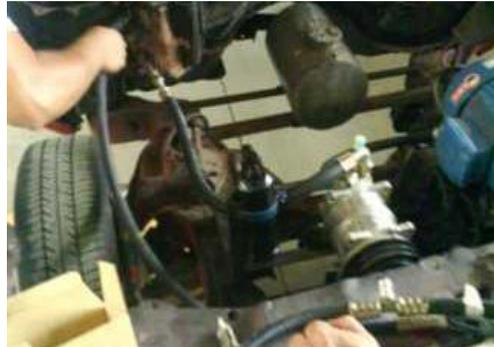
FIG-4.16 INSTALACIÓN DE BOTELLA SECANTE
