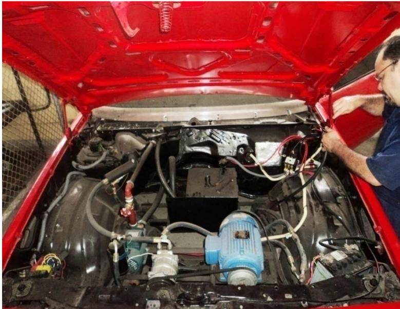
FIG-4.37 INSTALACIÓN DEL CONTACTOR ELÉCTRICO
