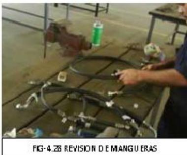
FIG-4.28 REVISIÓN DE MANGUERAS
