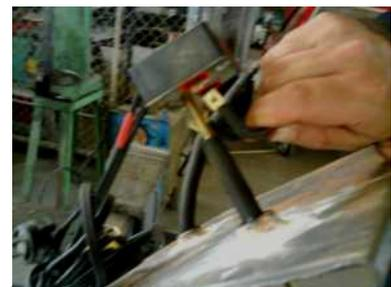
FIG-4.25 INSTALACION DE TERMOSTATO
