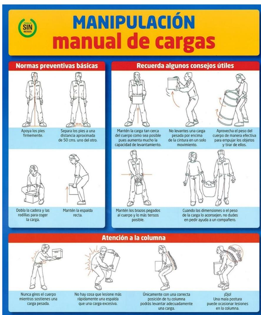
**Figura 4.7 Señalización ergonómica en puestos de trabajo**
