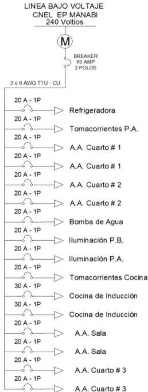
**Figura 2.4** Diagrama unifilar del circuito eléctrico de la vivienda caso estudio
