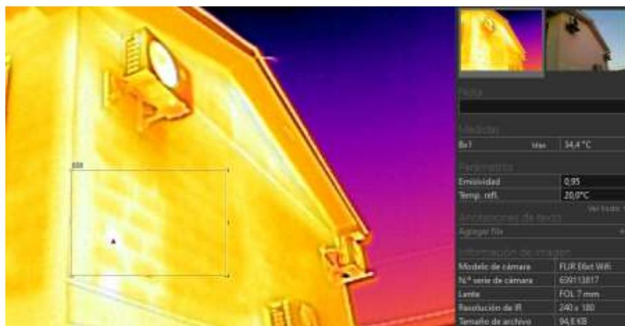
**Figura 3.25** Medición de temperatura en la parte exterior de la pared lateral de la planta alta
