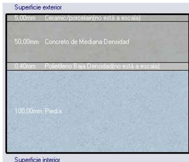
**Figura 3.74** Representación de los materiales constructivos del piso de la planta baja
