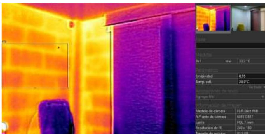
**Figura 3.28** Medición de temperatura en la parte interior de la pared lateral de la planta baja
