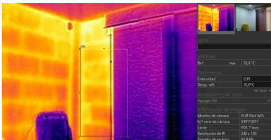
**Figura 3.32** Medición de temperatura en la parte interior de la pared de la fachada posterior de la planta baja
