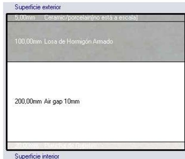
**Figura 3.75** Representación de los materiales constructivos del piso de la planta alta
