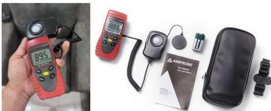
**Figura 2.9** Medición de Lux al interior de la vivienda con el Luxómetro LM-200LED
