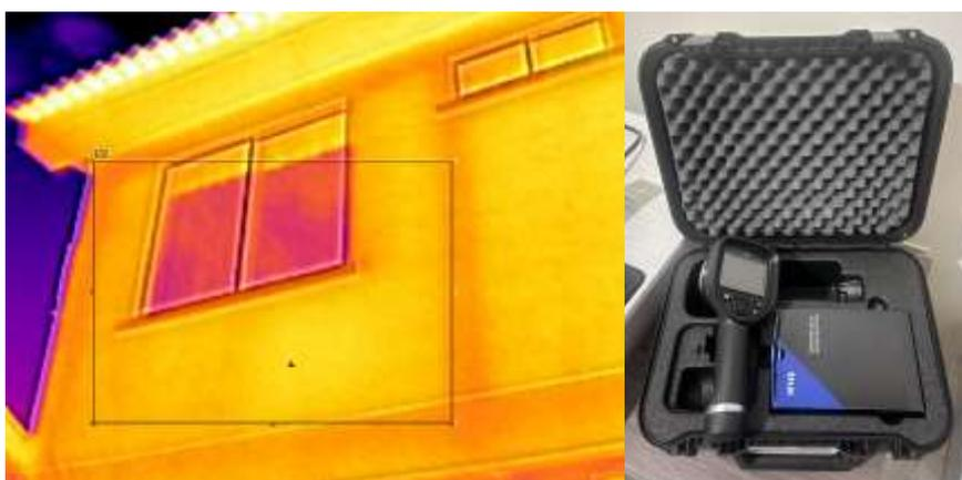
**Figura 2.10** Medición de temperatura de la envolvente con la cámara termográfica FLIR E6xt
