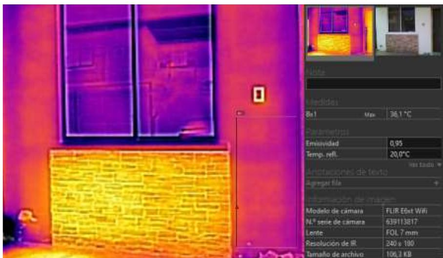
**Figura 3.23** Medición de temperatura en la parte exterior de la pared frontal de la planta baja
