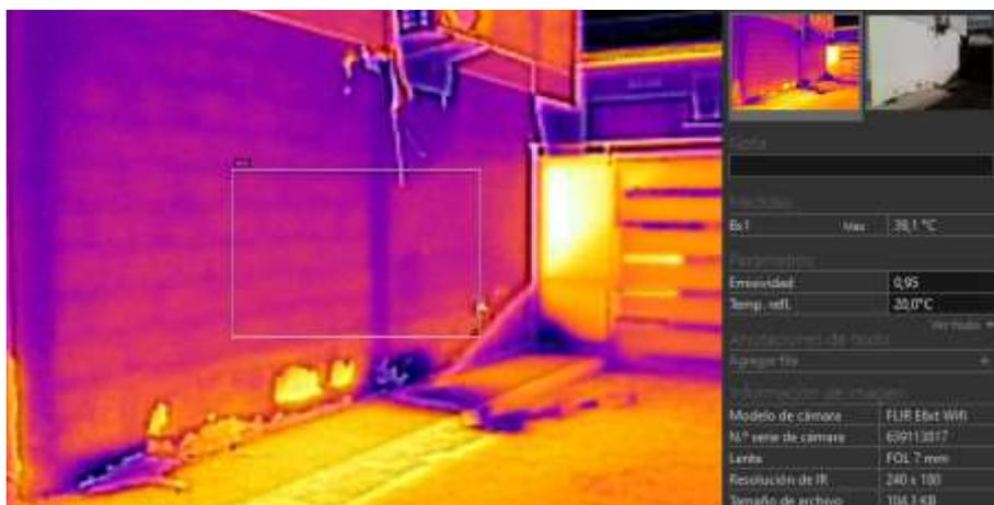
**Figura 3.27** Medición de temperatura en la parte exterior de la pared lateral de la planta baja
