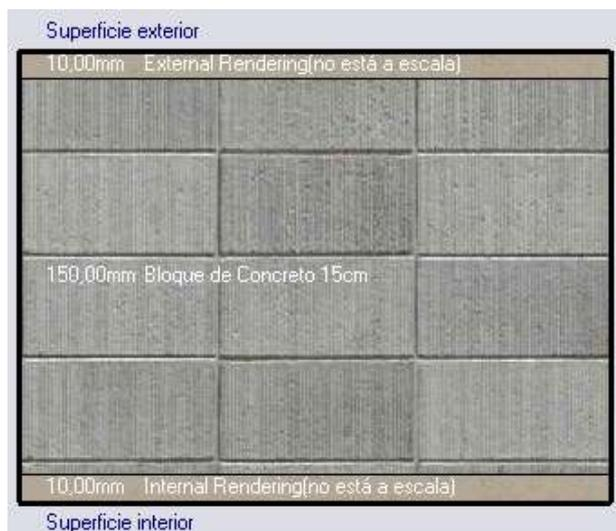
Figura 3.73 Representación de los materiales constructivos de las paredes
