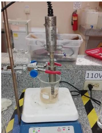
Figura 3.8. Elaboración de las películas de material compuesto mediante el método de evaporación de solvente asistido con sonicación.
