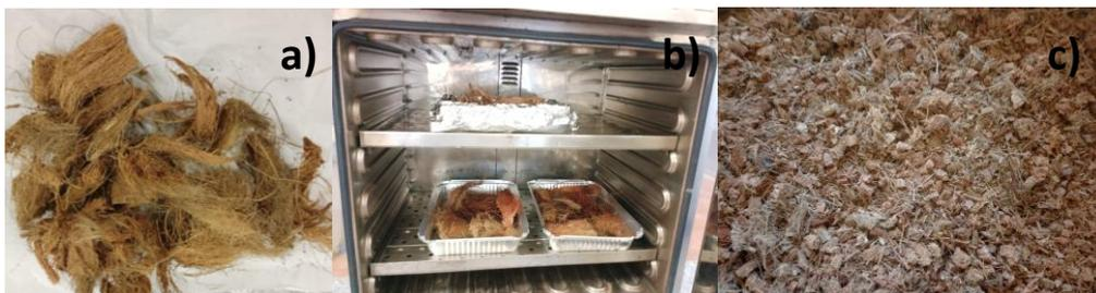
Figura 3.1. Material de reforzamiento: a) Fibra de coco, b) Fibra de coco lavada con agua destilada y secándose en el horno y c) Fibra de coco de largo de 0.5 a 1 cm.
