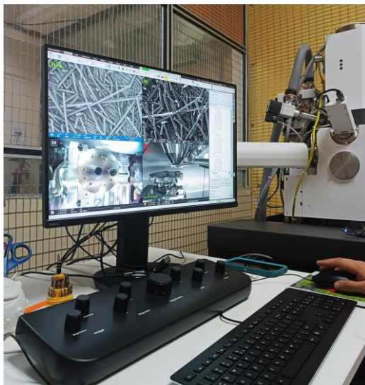
Figura 3.5 Equipos de microscopía electrónica analizando una muestra de fibra de carbono
