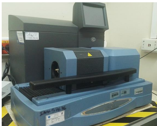
Figura 3.6 Equipo para el ensayo de análisis termogravimétrico (TGA)
