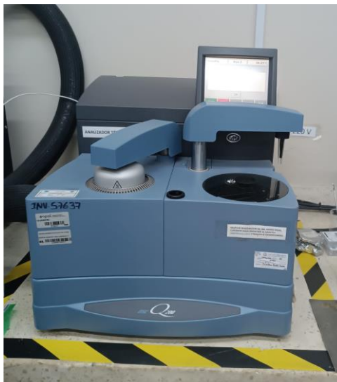
Figura 3.4 Fotografía del analizador térmico TA modelo Q200 utilizado realizar ensayos DSC
