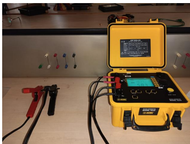
Figura 3.8 Medición de resistencia en los compuestos utilizando un microóhmmetro
