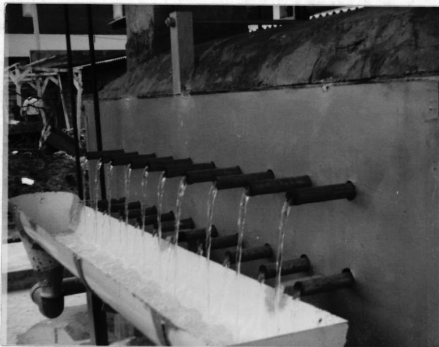
Fig. 2.1.b Banco de tubos (carga simulada), salida de a
