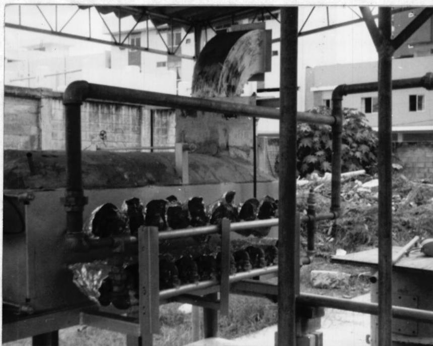
Fig. 2.1.a Banco de tubos (carga simulada), entrada de agua.
