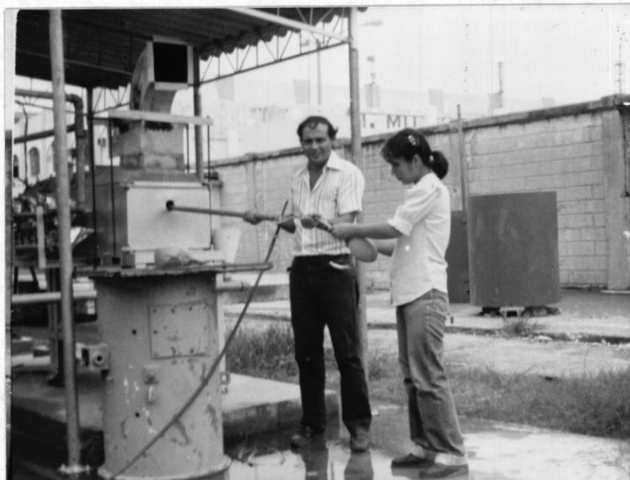
Fig. 2.6 Toma de muestra de gases de combustión.
