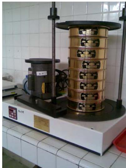
Fig. 2.8 Equipo de Tamizado
