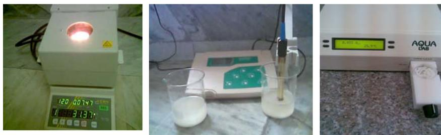
Fig. 2.1 Equipos utilizados para medir pH y humedad
