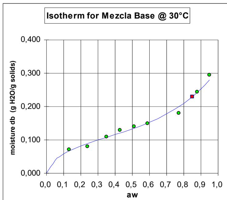
Fig. 3.1 Isotherma de adsorción de la mezcla base
