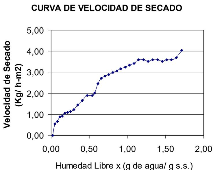
Fig. 2.6 Curva de Velocidad de Secado
