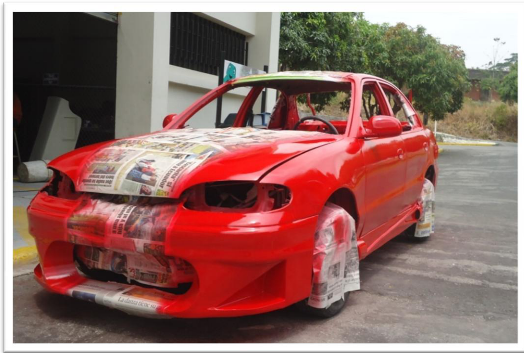
Fig. 49 Aplicación de la pintura Roja
