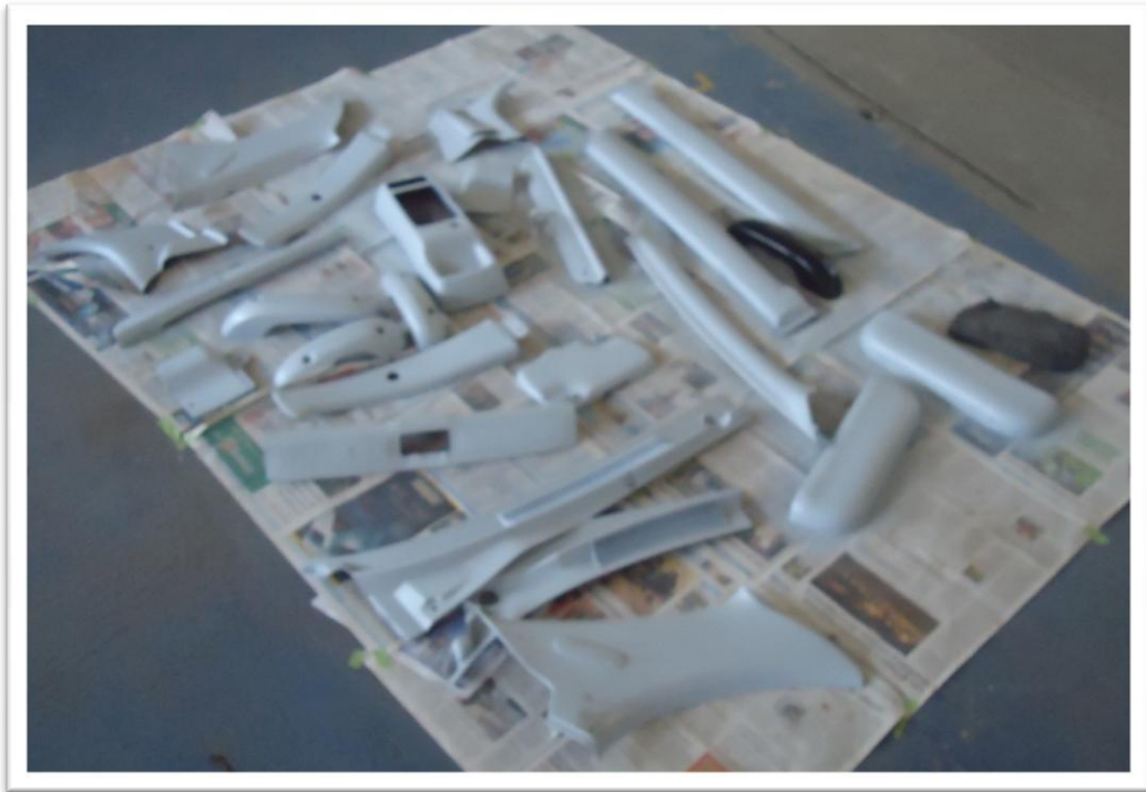
Fig. 50 Aplicación del fondo Mustang de piezas plásticas del interior del carro
