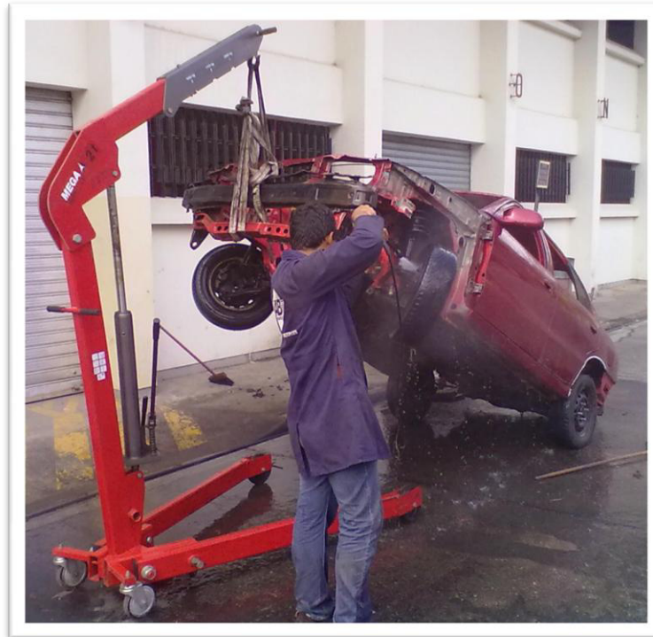
Fig. 43 Lavado total del vehículo desarmado
