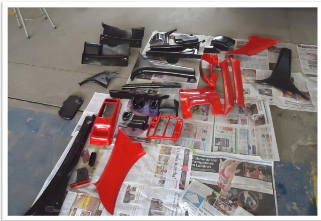
Fig. 51 Aplicación de pintura en piezas plásticas del interior del vehículo.
