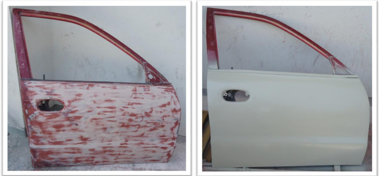
Fig. 47 Arreglo en latería y pintado de puertas.
