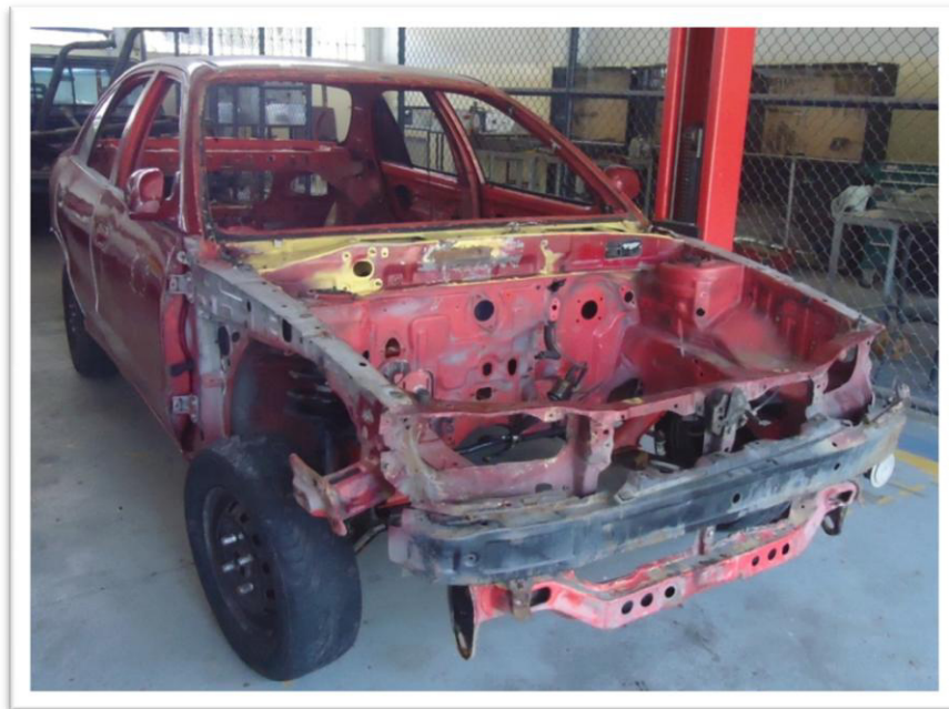
Fig. 32 Desmontaje parte frontal del vehículo
