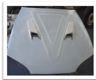
Fig.21.-Modificación del capot
