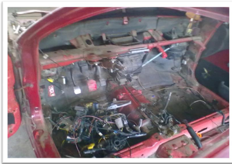
Fig. 30 Desmontaje de todo los arnés del vehículo
