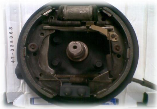
Fig. 12.- Conjunto de zapatas armado.
