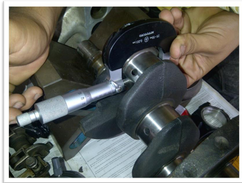
Fig. 37 Medición del ovalamiento del muñón de biela del cigüeñal
