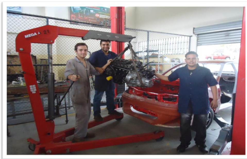
Fig. 46 Montaje del motor en el vehículo.
