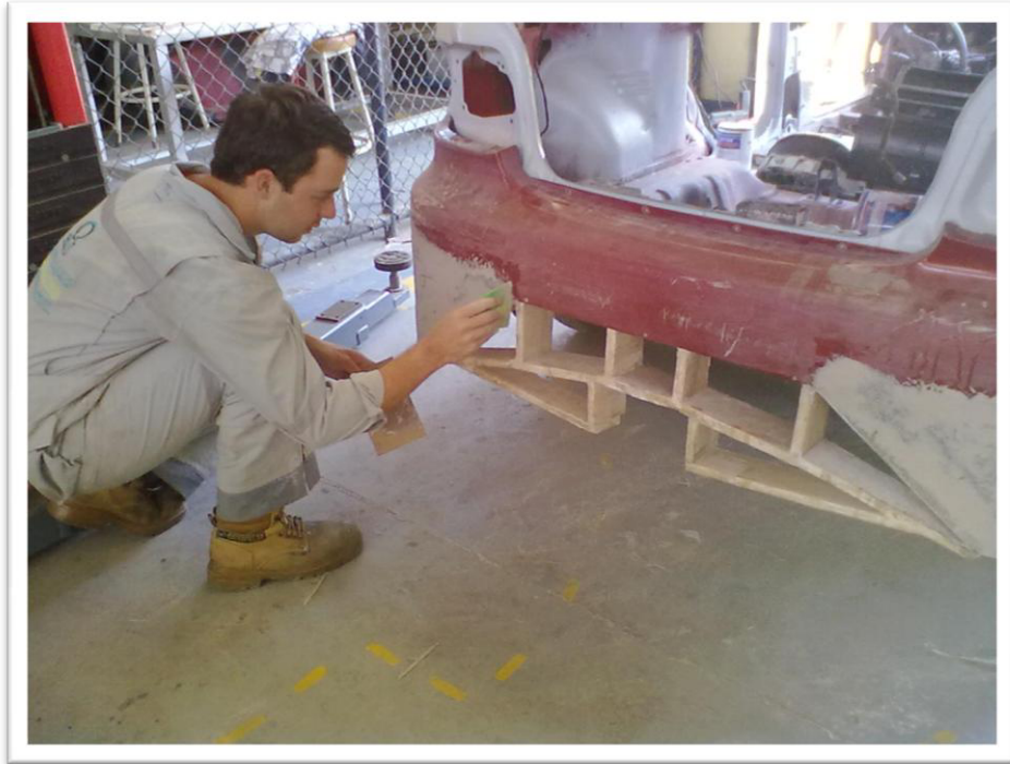
Fig. 21.- Aplicación de la masilla "Mustang"
