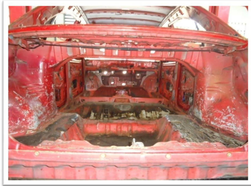
Fig. 31 Desmontaje total partes interior vehículo
