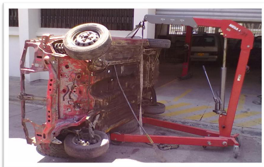
Fig. 43 Lavado total del vehículo desarmado
