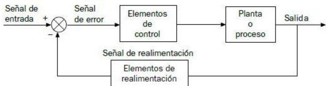
Figura 1.9 Sistema de control de lazo cerrado
