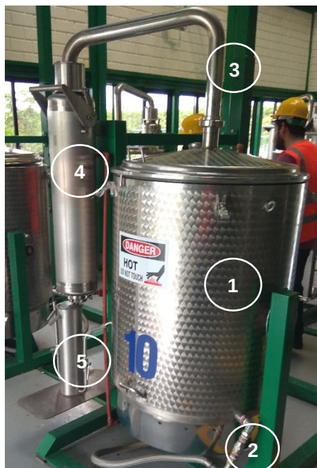
Figura 1.2 Reactor de destilación empleado para la obtención de datos
