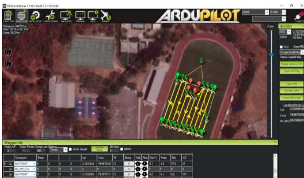
Figura 3.7. Software Open Source Mission Planner con recorrido esquivando el obstáculo
