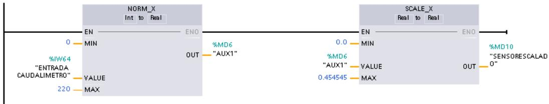
La salida del bloque PID es un número real entre 0 y 100, donde 100 indica que el PID logro estabilizarse en el setpoint de entrada. Para el caso del variador se acondicionó la señal de salida del bloque PID de tal manera que cuando sea 100 se envía un valor de voltaje equivalente al setpoint de entrada a través de la salida analógica hacia el variador tal como indican el segmento de programación 4.
