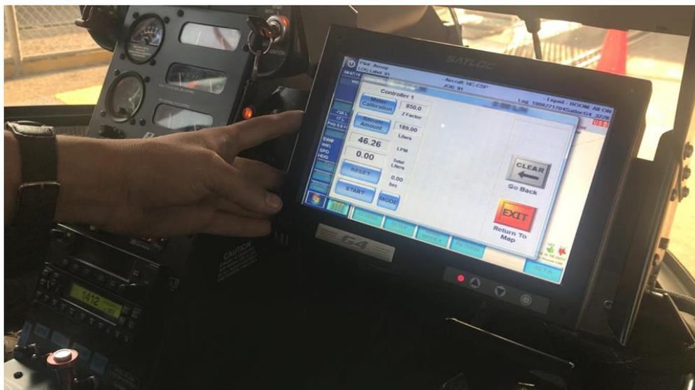
Figura 3.9 Pantalla de calibración de turbina de flujo
