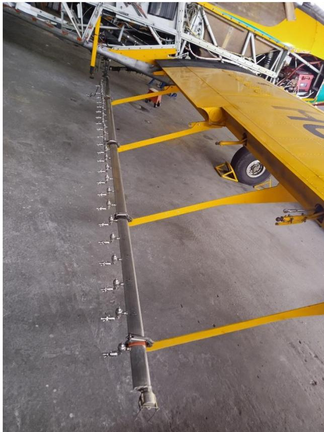
**Figura 1.10 Barra de pulverización del Thrush**
