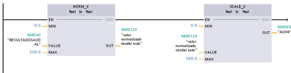
Para la entrada del PID se normalizo y escalo la señal del sensor de caudal porque input del PID solo acepta valores reales entre 0 y 100.
