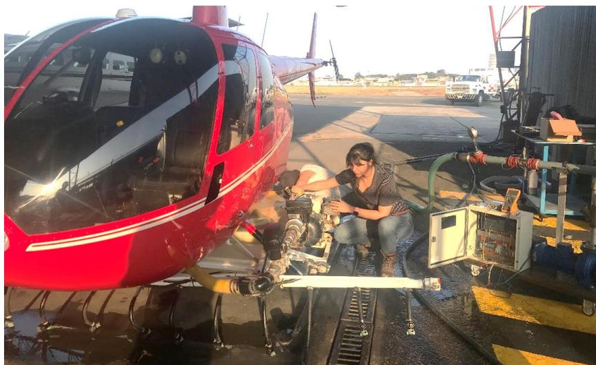
**Figura 3.7 Sistema de calibración en helicóptero Robinson R44**
