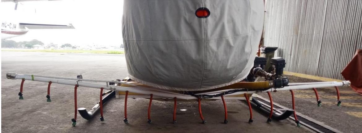
**Figura 1.11 Barra de pulverización Robinson R44 Raven I**
