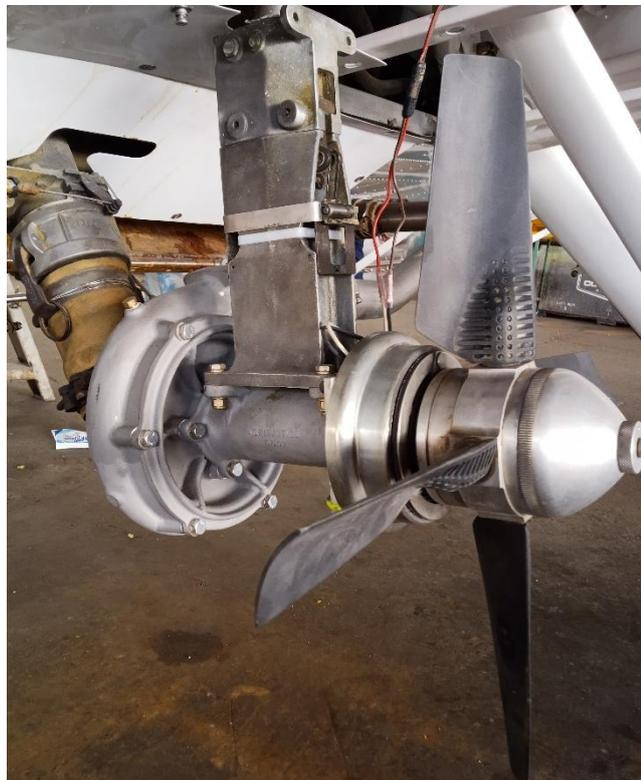
**Figura 1.7 Ventilador de la bomba de pulverización**
