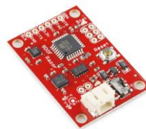
Figura 1.5 IMU de 9 grados de libertad con sensores integrados [15]
