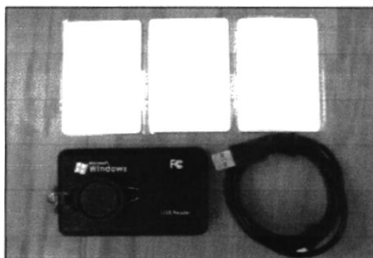
Figura 2-14. Equipo de clonación de tarjetas RFID
