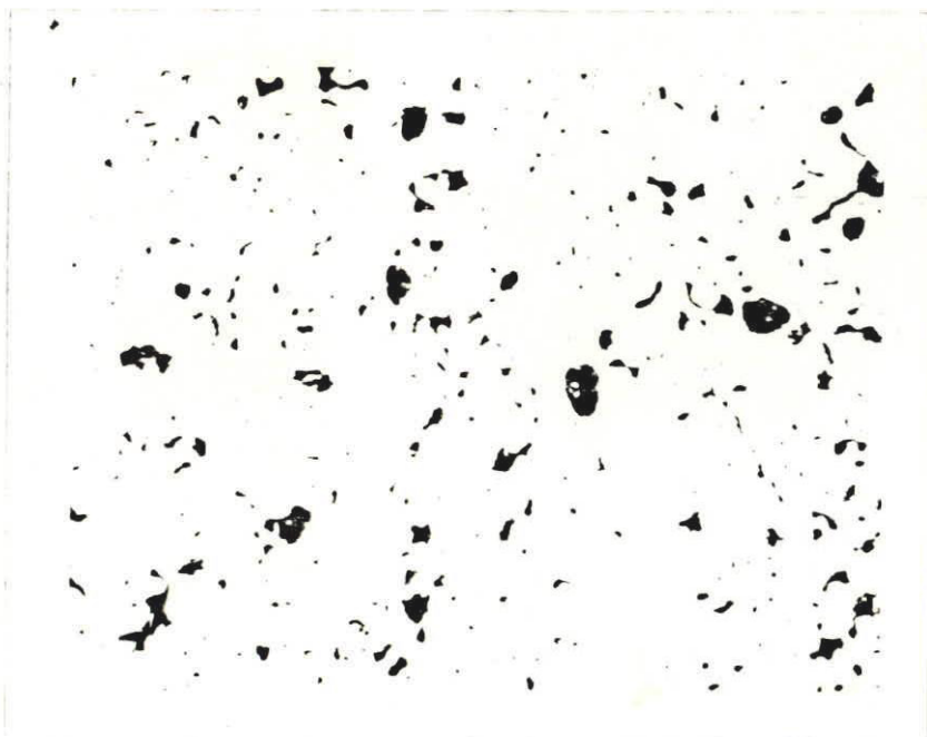
Fig. N° 20.- Bronce centrifugado 80-10-10. Elaborado en la primera colada de esta tesis, sin ataque químico, 100x.
