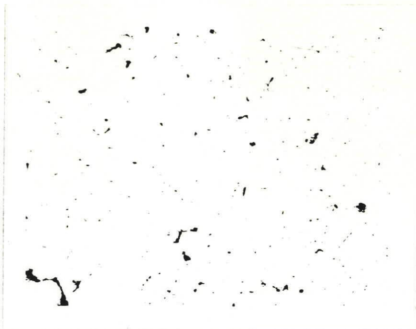
Fig. N° 19.- Bronce de composición desconocida, usado para cojinetes de molinos de caña. Procedencia colombiana, sin ataque químico, 100x.
