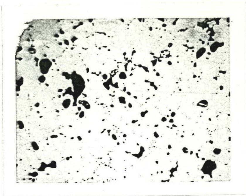
Fig. N° 23.- Bronce centrifugado 80-10-10, elaborado en la tercera colada, sin ataque químico, 100 x.
