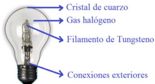
Figura 1.1. Elementos principales de la lámpara halógena. Fuente: OSRAM
