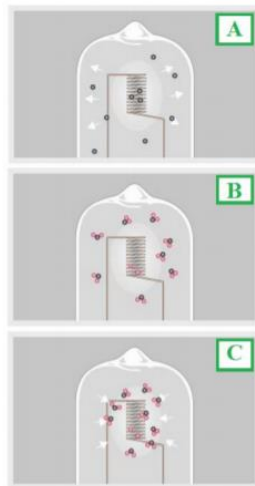
Figura 1.2. Ciclo del Halógeno. Fuente: OSRAM
