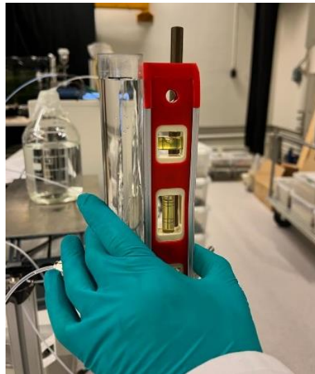
A. NIVELACIÓN DEL EMPAQUETAMIENTO DE ARENA
