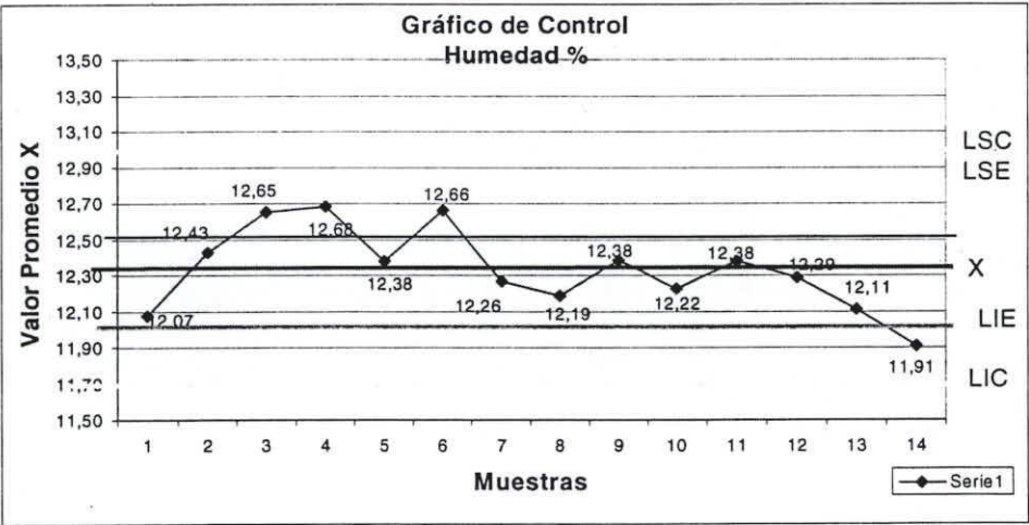
FIG. 3.30 GRAFICO DE CONTROL DE HUMEDAD
