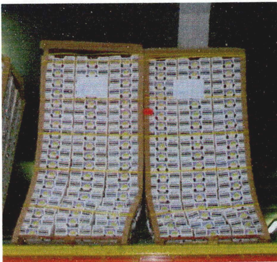
Figura 2. 18 Defectos en el palletizado
