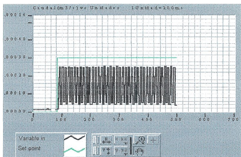
FIGURA 5.24. GRÁFICA DE REPUESTA DEL SISTEMA A UN SALTO ESCALÓN DE 0.0 \text{ m}^3/\text{s} A 0.003 \text{ m}^3/\text{s} , CON K_C = 1.4
