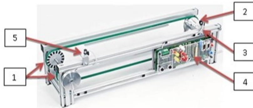
FIGURA 1.3: Cinta transportadora doble equipada con un motor DC de 24 V
