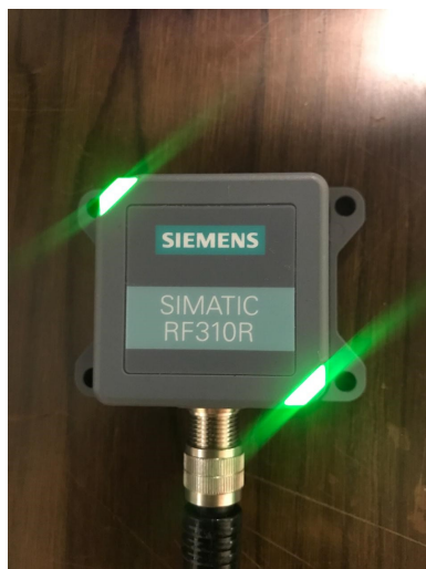
FIGURA 3.8: Lector preparado para el proceso de lectura
