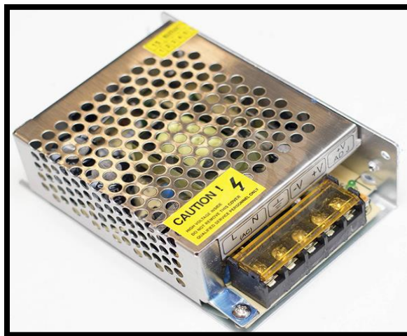
Figura 2.28 Fuente de 12V a 2A para energizar el nodo principal [Autoría Propia]
