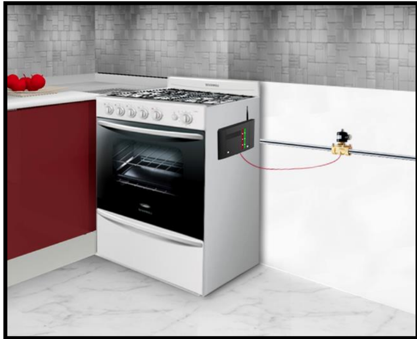
Figura 2.12 Ubicación del nodo principal junto a una tubería de GLP [Autoría Propia]
