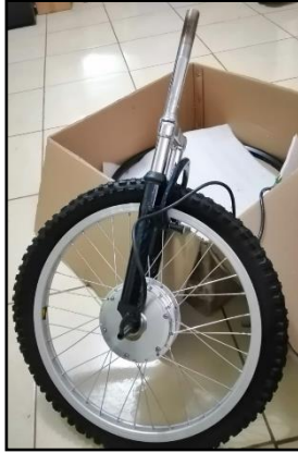
Figura 3.15 Montaje de la llanta en la horquilla
