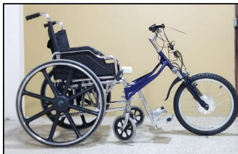
Figura 3.22 Dispositivo motorizado acoplado a la silla de ruedas convencional
