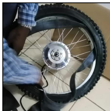
Figura 3.14 Montaje del tubo y llanta
