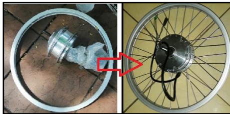
Figura 3.13 Llanta con aro reducido
