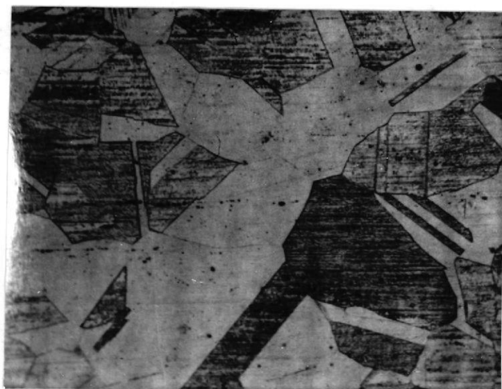
Fé. 41.- COMPARACION DE MICROESTRUCTURAS EN EL ACERO INOXIDABLE AUSTENITICO TIPO 304 DESPUES DE DIFERENTES TRATAMIENTOS TERMICOS ( X 200 )
