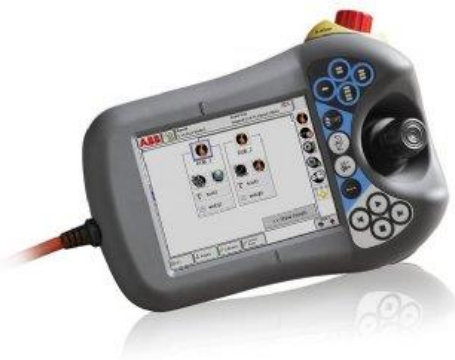
Figura 1.5 Teach pendant de la marca ABB
