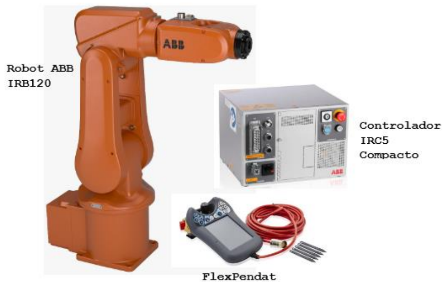
Figura 2.2 Elementos del sistema robótico ABB IRB 120
