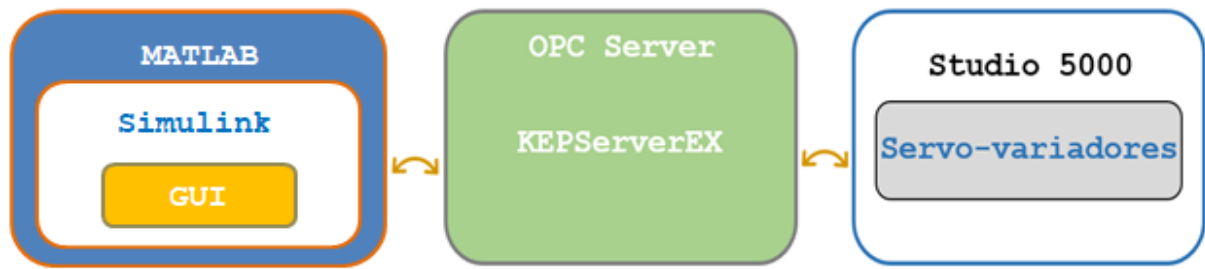
Figura 2.1 Diagrama de la aplicación de simulación de un robot de 6 GDL orientado a servomotores
