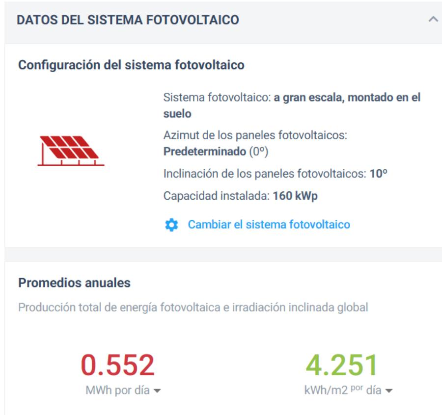
*Nota:* La radiación presente es calculada por un factor de corrección debido a una inclinación de 10°. Tomado de Global Solar Atlas (<https://globalsolaratlas.info/map?s=-2.144365,-79.966934&m=site&c=-2.14458,-79.966736,11&pv=ground,0,10,160>)
