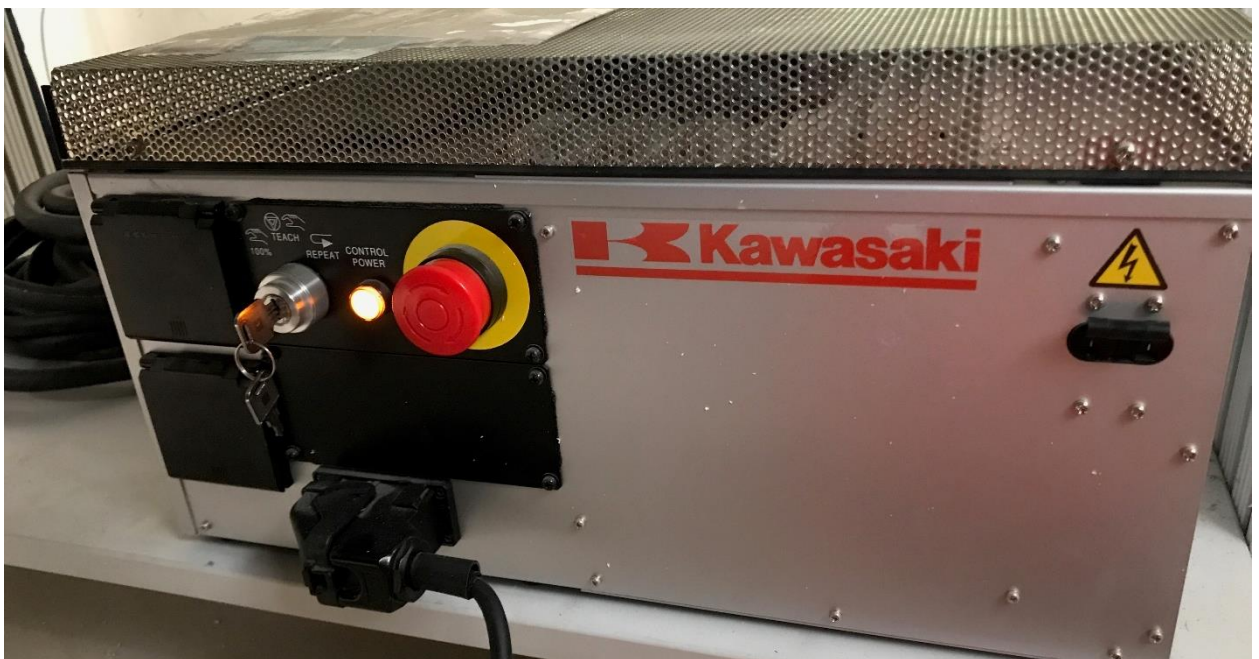
Figura 2.12 Controlador del robot F60 Controller vista frontal
