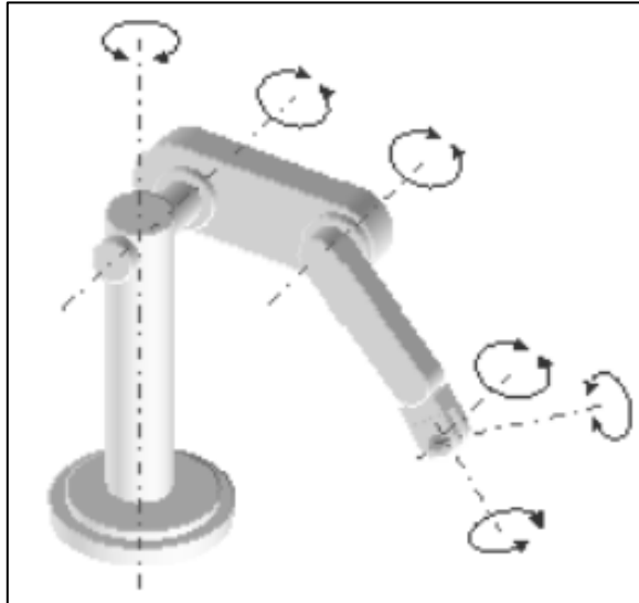
Figura 1.3 Brazo robótico con seis grados de libertad [2]
