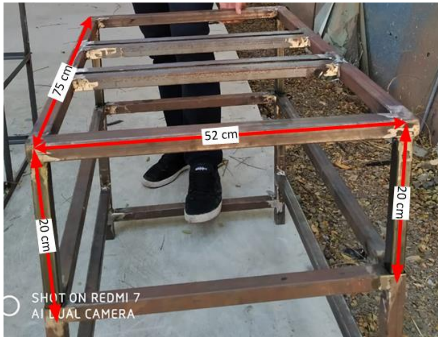
Figura 4.2 Mesa para ajustar la altura de la plataforma giratoria
