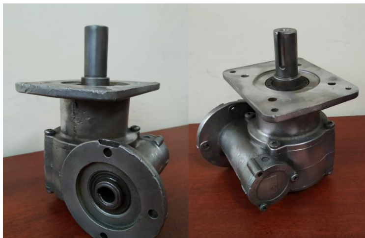
Figura 4.6 Engranaje para reducción de vueltas
