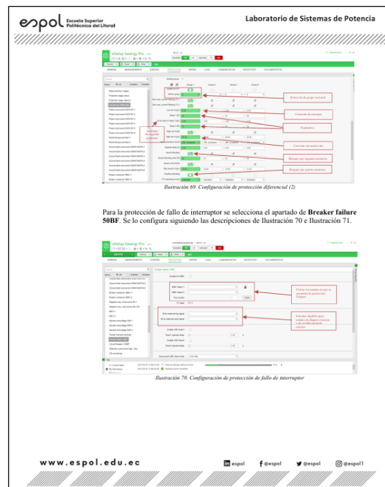
Figura 3.12: Configuración de la protección diferencial en la guía de parametrización
