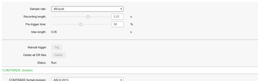
Ilustración 32. Ratio de muestreo, tiempo de muestra previo al disparo y longitud de registro Easergy Pro
