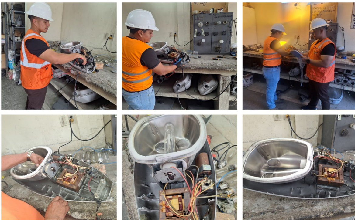
Mediciones de parámetros eléctricos de luminarias de sodio registrados en el taller de alumbrado público en Guayaquil
