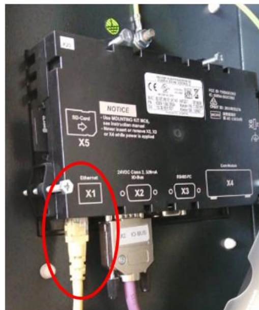
Figura 3.20 Conexión con el puerto Ethernet del controlador
