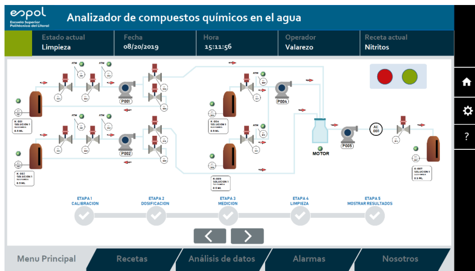
Figura 3.9 Pantalla del diagrama P&ID del sistema.
