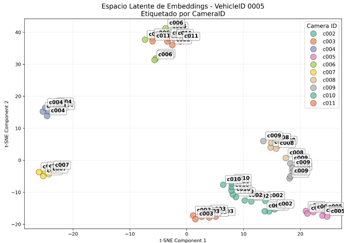
Un caso particular se da en el vehículo con ID 5 en el que se puede observar que las tomas borrosas o con un enfoque diferente se encuentran totalmente a la izquierda (cámara 4 y 7 respectivamente) en el espacio vectorial (compárese con figura 3.1.2). Otro caso se da en las tomas de la cámara 8 y 9 donde existen obstrucciones parciales del vehículo y al graficarlos se encuentran cercano el uno del otro.
