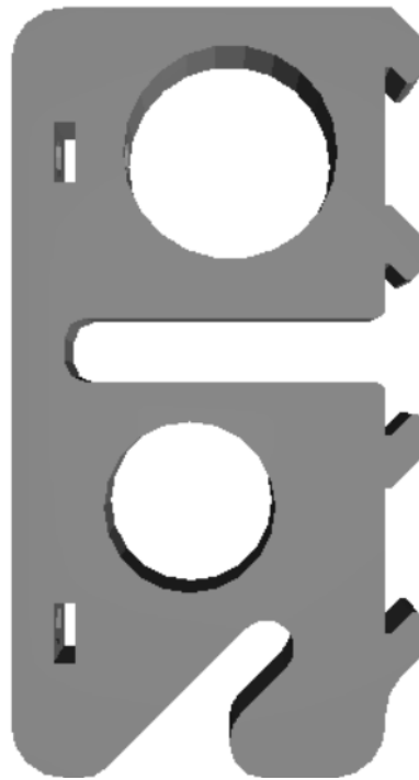
Imagen 3. Modelo de base para sujeción de switch de 8 puertos rj45, vista frontal
