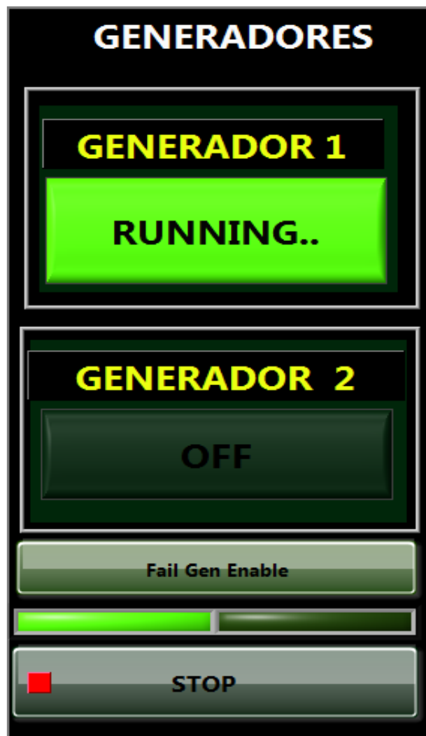
Figura 2.3 Pantalla de interfaz con controlador PLC.
