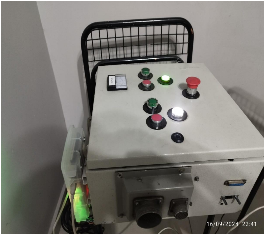
Figura 3.17 Vista frontal del tablero, elementos de mando y luces pilotos.
