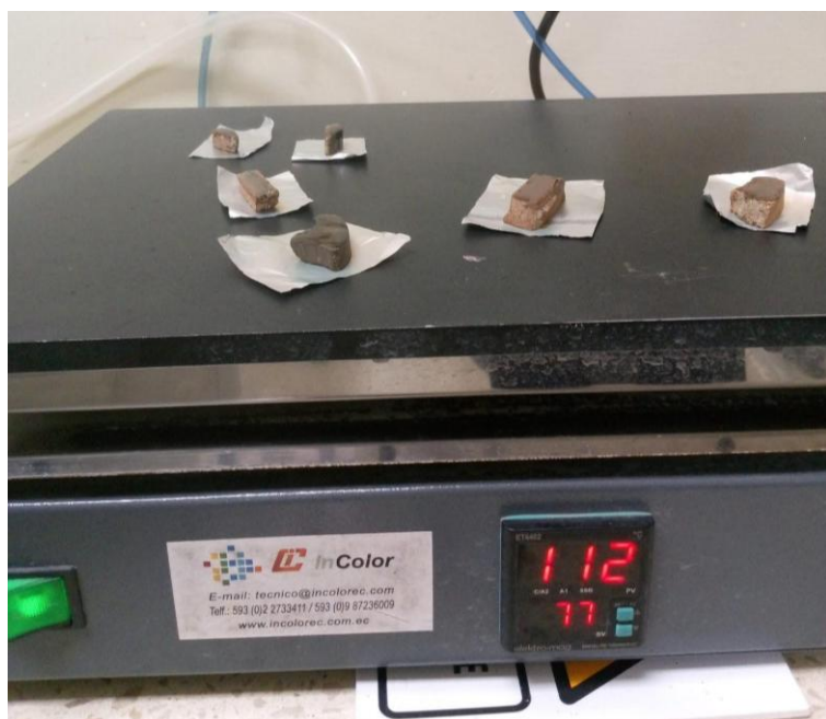
Figura 24. Grupo A sobre máquina de calor después de cubrir las piezas con resina
